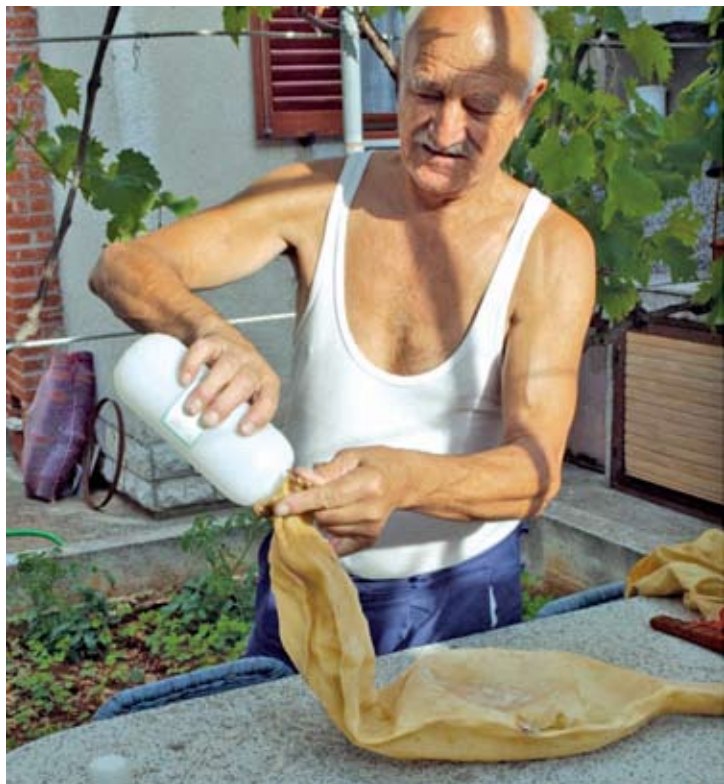
Proces izrade meha: utakanje glicerinovog ulja (Ivan Muži , Cres)
